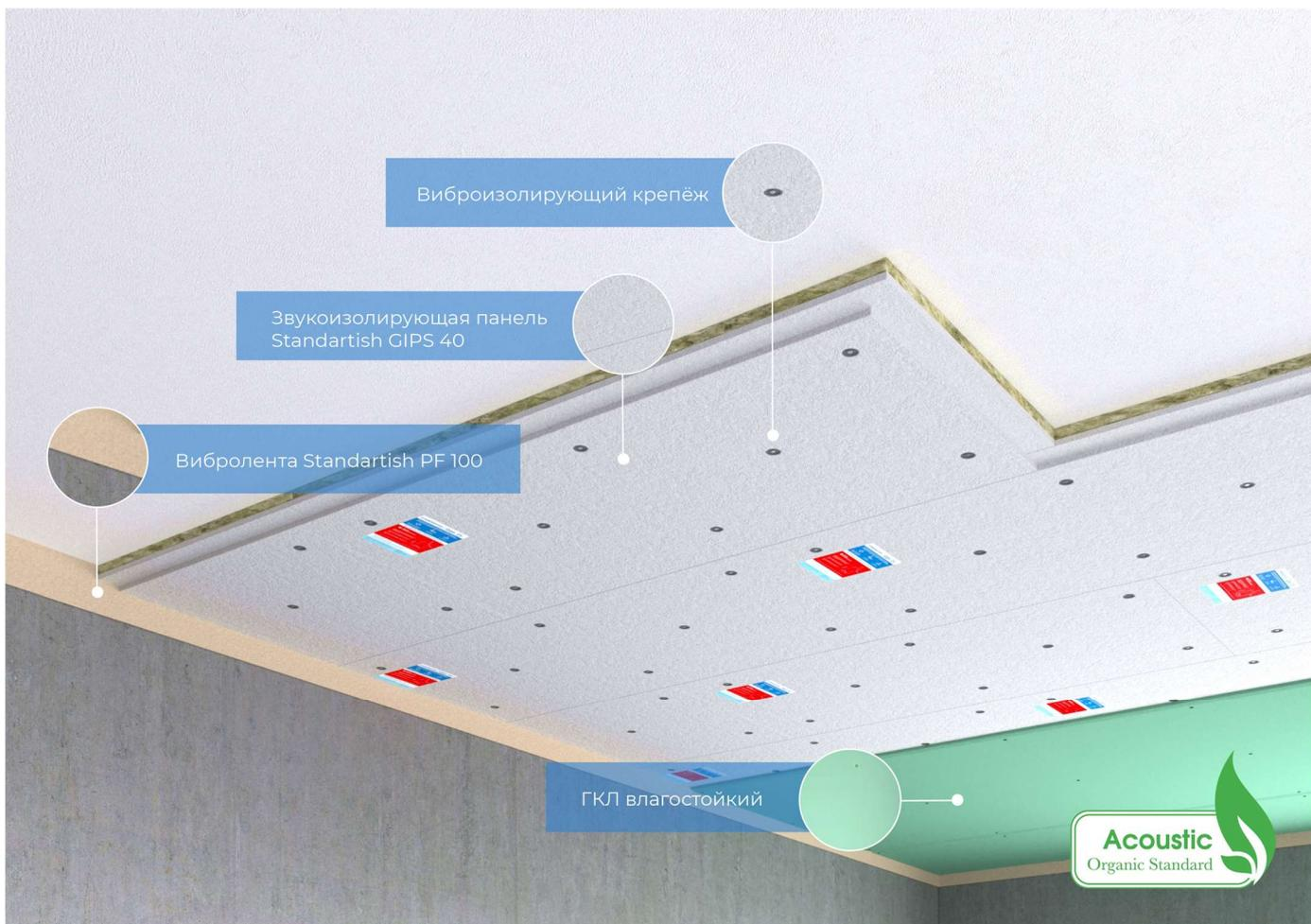
**Шаг 1** Перед началом монтажных работ панели STANDARTISH STEP необходимо выдержать в помещении в горизонтальном положении. Монтаж панелей производится на выровненную поверхность стен или потолков.
